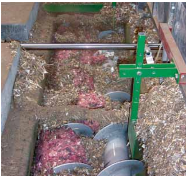
Sekoitusruuvi, joka sekoittaa seosaineen ja jauhetun sivutuotteen. (Kuva Preseco Oyl/Jan Granlund)
